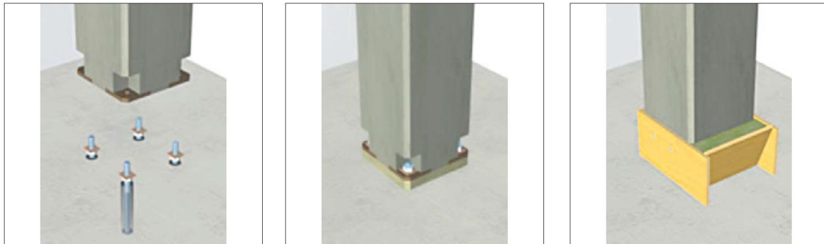
Pilt 4. Konstruktsioonelemendi monolitiseerimine
